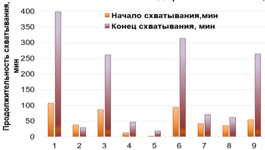
Рис. 6. Влияние компонентного состава щелочеактивированных вяжущих на их сроки схватывания: 1 – Ш; 2 – ЦГ; 3 – Ш+ЦГ; 4 – Ш+NaOH; 5 – Ш+Na 2 SiO 3 ; Ш+Na 2 CO 3 ; Ш+ЦГ+NaOH; Ш+ЦГ+ Na 2 SiO 3 ; Ш+ЦГ+ Na 2 CO 3
